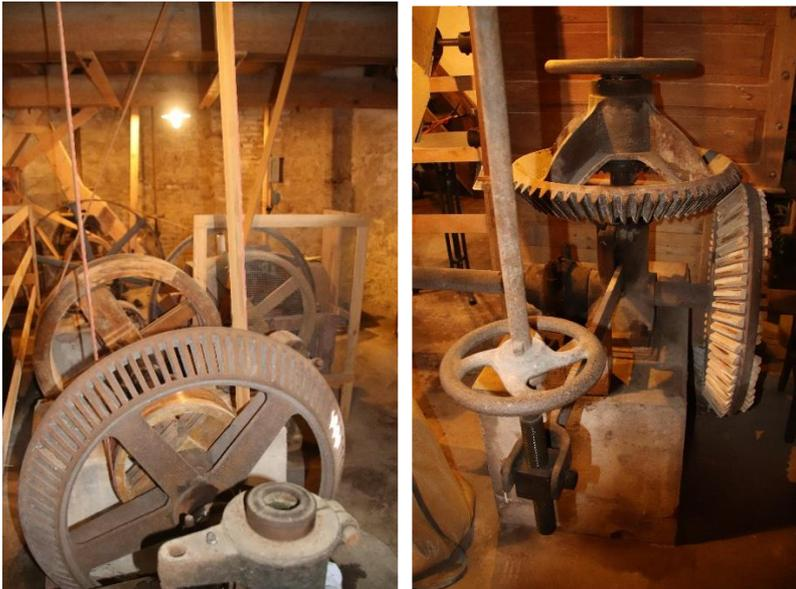
Eine zentrale Kraftquelle (der **Schleifringmotor**, Wasser oder Windkraft, eine Dampfmaschine, o.ä.) dient zum Betrieb von weitauseinander stehenden Maschinen. Der Motor in der Holzhauser Mühle ist ein 11 kW Motor und hat eine Nenndrehzahl von 950 U/min.
