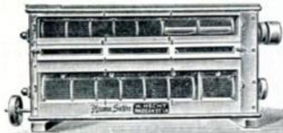
Der Askania-Sichter funktioniert nach dem Prinzip einer Salatschleuder.
